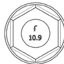
Identificación de la resistencia a la tracción del tornillo
