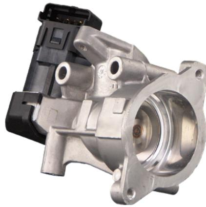
**DE** Nach dem Einbau des AGR-Ventils muss von einem FIAT/Citroën/Lancia/Peugeot/Volvo-Vertragshändler zwingend ein Software-Update des Motorsteuergerätes durchgeführt werden.
