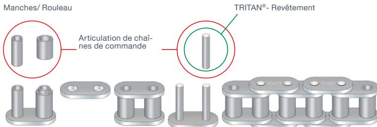
Les chaînes de commande, exécutées en tant que chaînes à douilles ou que chaînes à rouleaux, consistent en une disposition de maillons de chaîne internes et externes. Les boulons et les douilles forment ici les surfaces des articulations.
