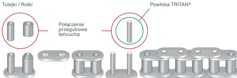
Różne wersje łańcuchów rozrządu – tulejkowe lub rolkowe – zbudowane są z połączonych ze sobą ogniw wewnętrznych i zewnętrznych. Sworznie i tulejki tworzą połączenia przegubowe.
