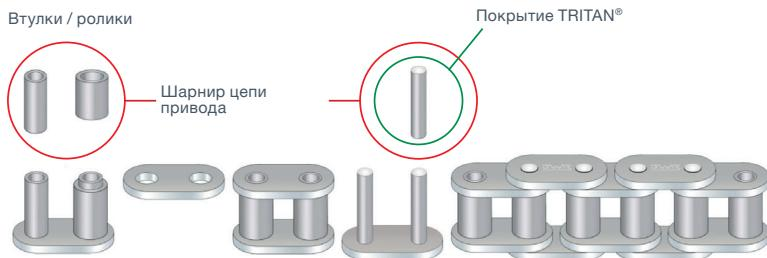
Цепи привода (втулочные и роликовые), состоят из внутренних и внешних звеньев. В качестве рабочих поверхностей шарнира используются сопряженные части валика и втулки.
