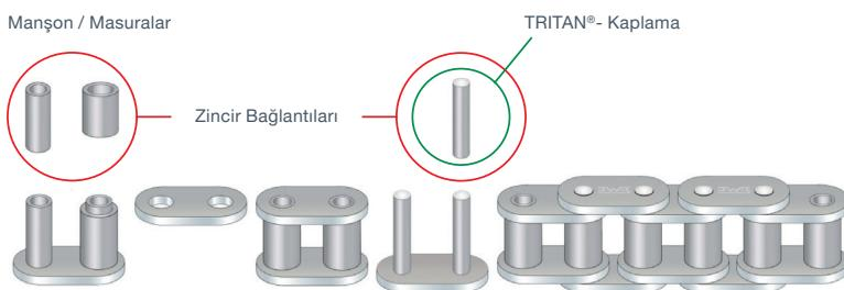
Burçlu veya makaralı olarak dizayn edilen eksantirik zincirler, iç ve dış bağlantı noktalarına sahiptir. Bu nedenle pimler ve masuralar üzerinde bir ek yüzey alanı oluşur. Yağ kalitesinin azalmasıyla beraber zincir üzerinde bir yıprama meydana gelir, yağ, karbon ve yakıt karışımı bağlantı noktalarında aşınmalara neden olur. Özellikle turboşarj direk enjeksiyonlu motorlarda zincirde bir esnemeye neden olurlar.
