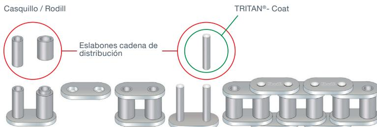
Las cadenas de distribución, diseñadas como cadenas de casquillos o cadenas de rodillos, consisten en una disposición de eslabones de cadena internos y externos. En este caso, los pasadores y los casquillos forman las superficies de las juntas.
