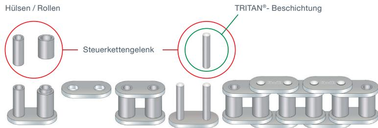
Steuerketten, ausgeführt als Hülsenketten oder Rollenketten, bestehen aus einer Anordnung von inneren und äußeren Kettengliedern. Die Gelenkflächen bilden dabei Bolzen und Hülsen.
