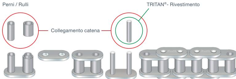
Le catene di distribuzione, progettate come catene a bussola o catene a rulli, consistono in una disposizione di collegamenti interni ed esterni. In questo caso, i perni e le boccole formano le superfici articolari.
