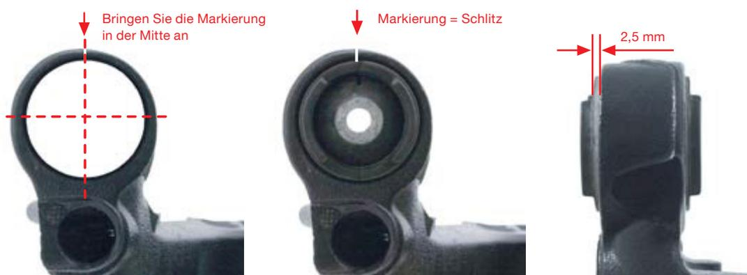
Der Schlitz am neuen Gummilager muss zur Markierung am Längslenker ausgerichtet sein und anschließend das Lager mit einem geeigneten Spezialwerkzeug eingepresst werden, bis zu einem Überstand von 2,5 mm.
