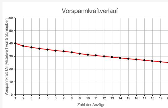
wird. Dies führt zu einer Verlängerung der Befestigung bis hin zur plastischen Verformung (siehe Bild 3).
