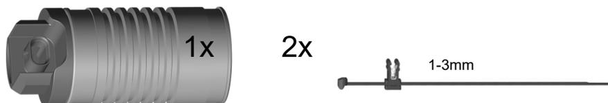
Originale Dämpfersteuerungsleitung in die mitgelieferte Stilllegung einstecken. Auf die korrekte Verriegelung des Steckers achten! Stilllegung und Leitung mit Kabelbindern / Edge Clips an der Fahrzeugkarosserie befestigen.
