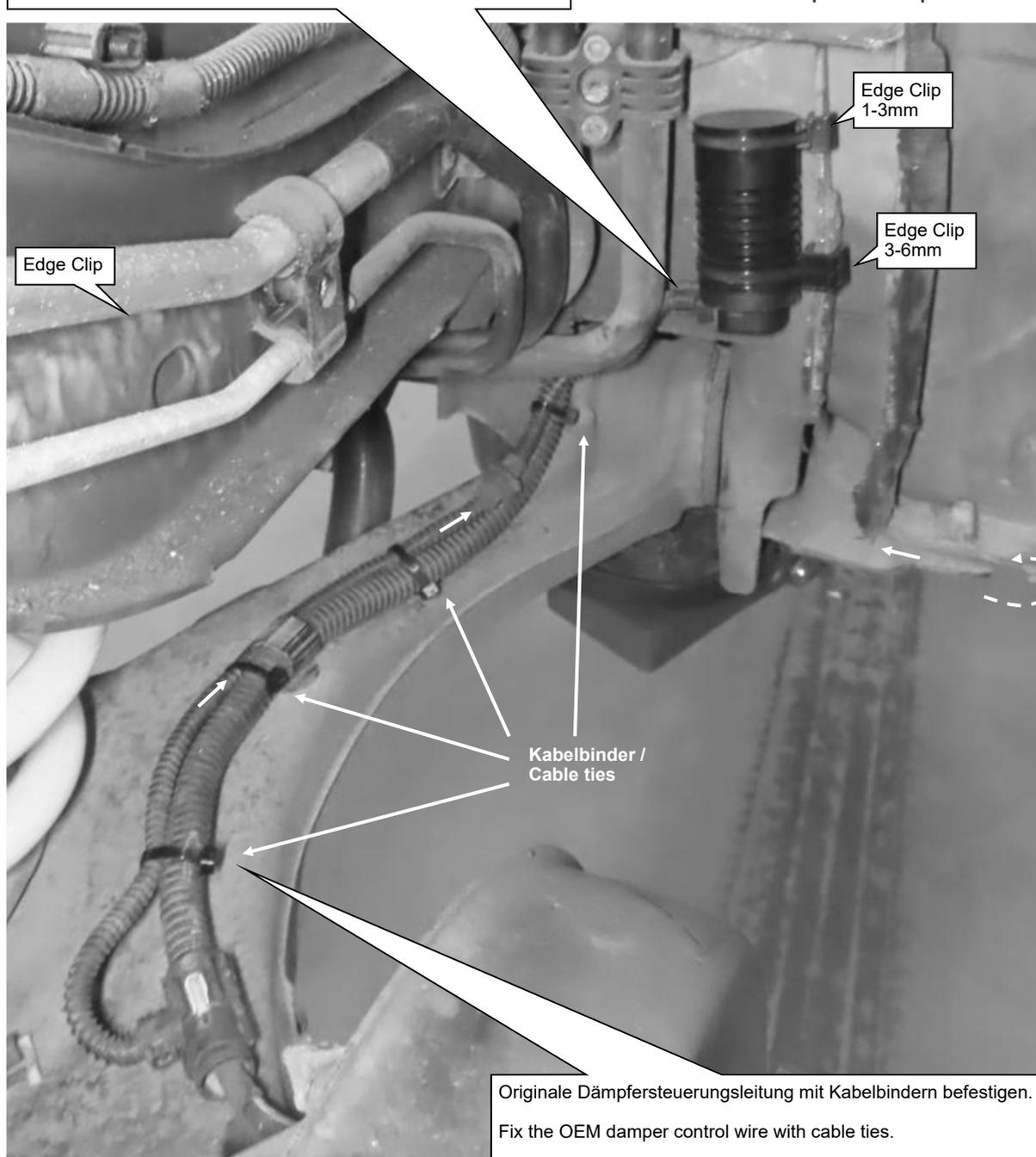
Originale Dämpfersteuerungsleitung mit Kabelbindern befestigen.
