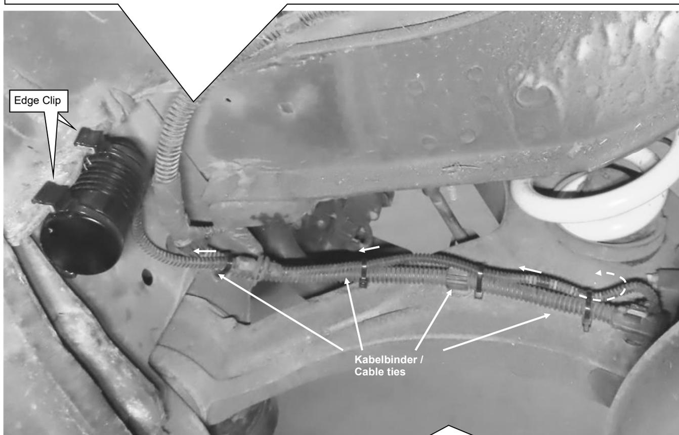
Originale Dämpfersteuerungsleitung mit Kabelbindern befestigen.
