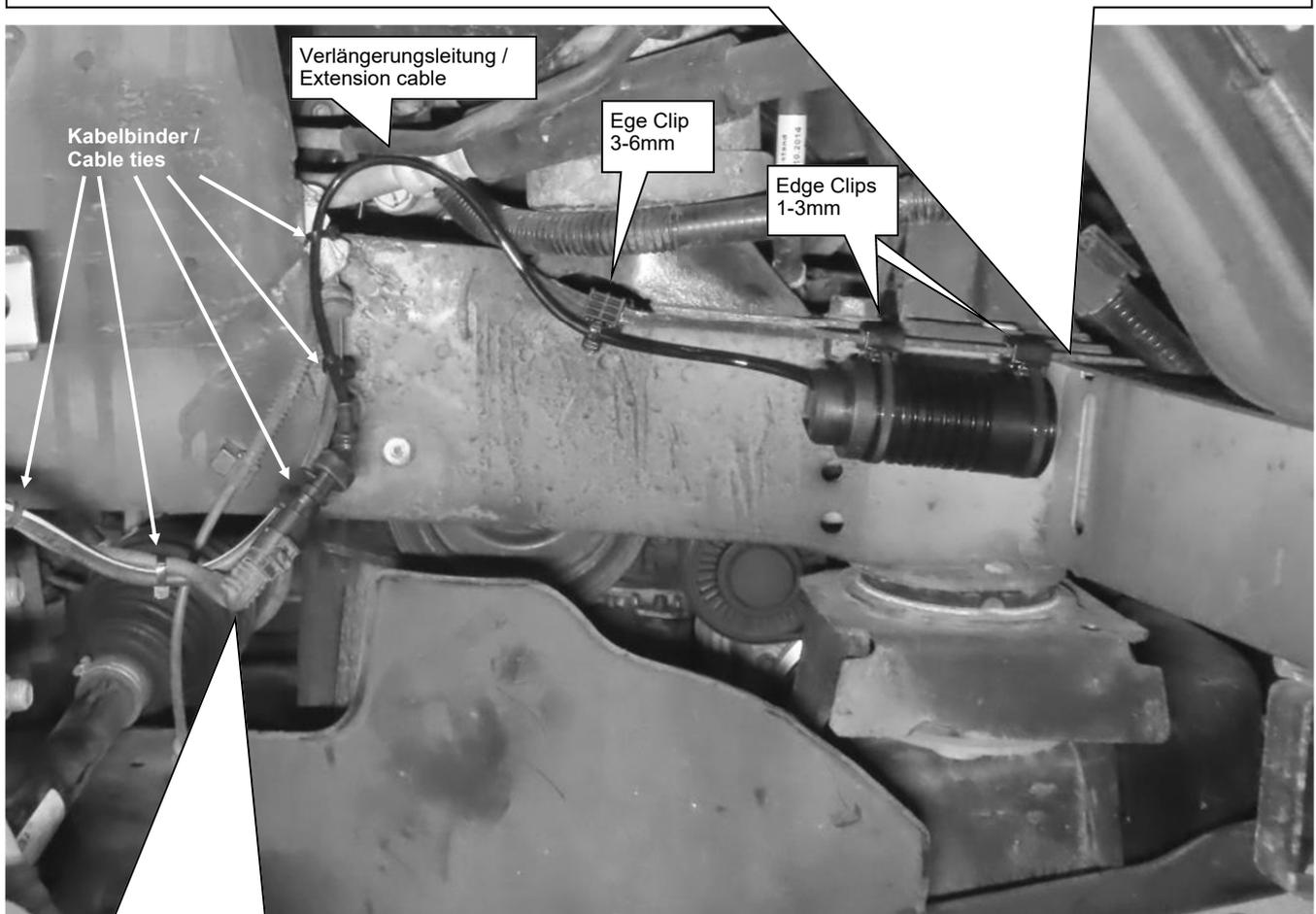
Originale Dämpfersteuerungsleitung mit Kabelbindern befestigen.
