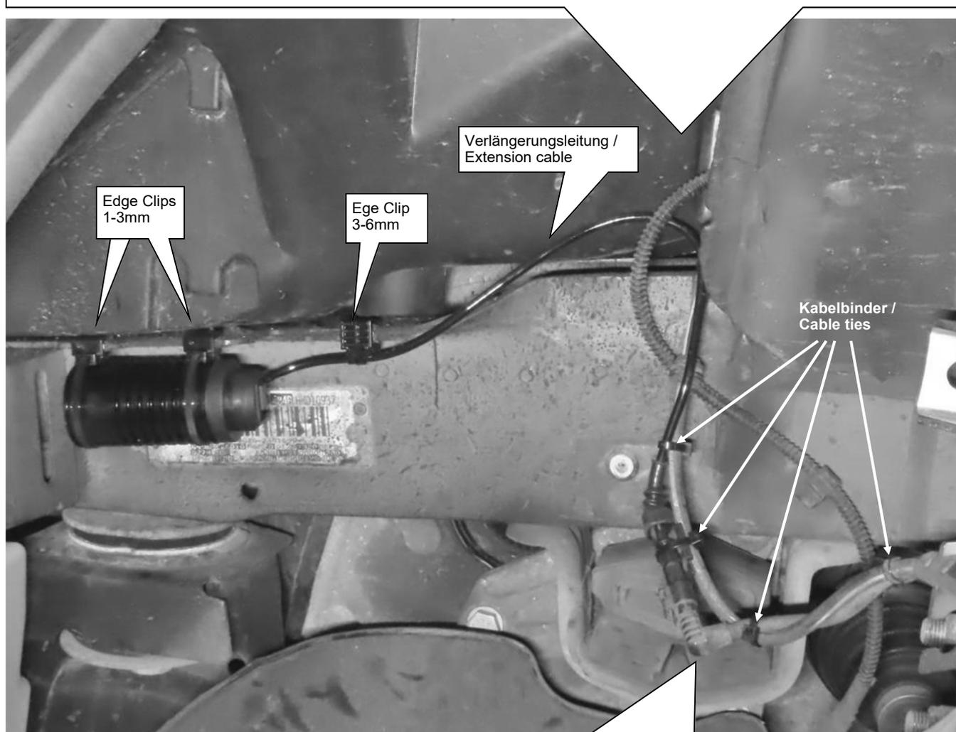
Originale Dämpfersteuerungsleitung mit Kabelbindern befestigen.
