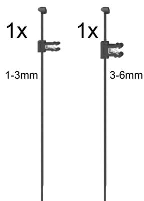
Originale Dämpfersteuerungsleitung in die mitgelieferte Stilllegung einstecken. Auf die korrekte Verriegelung des Steckers achten! Stilllegung und Leitung mit Kabelbindern / Edge Clips an der Fahrzeugkarosserie befestigen.
