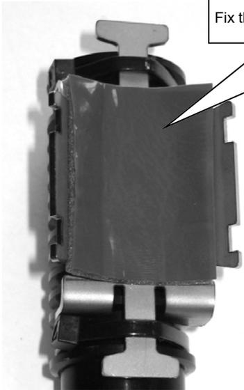
Klebeband auf den montierten Halter ankleben.
