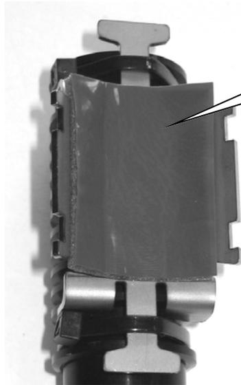
Elektronikbauteil am Dämpfer mit dem Klebeband und Kabelbinder 4,8mm x 290mm befestigen.
