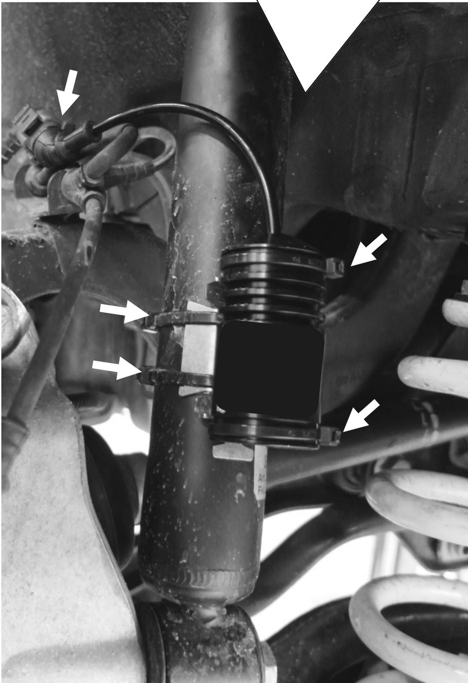
Klebeband auf den montierten Halter ankleben. **WICHTIG: Klebefläche muss Staub- und Fettfrei sein.**
