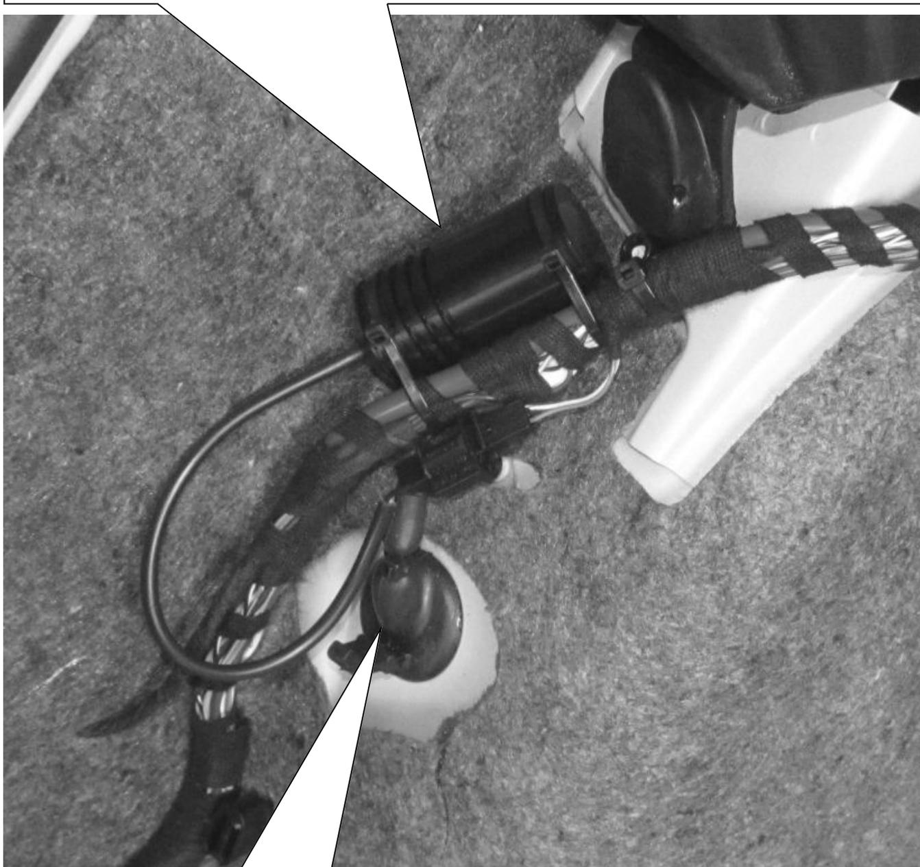
Original Kabeltülle mit einem Kabelbinder verschließen.
