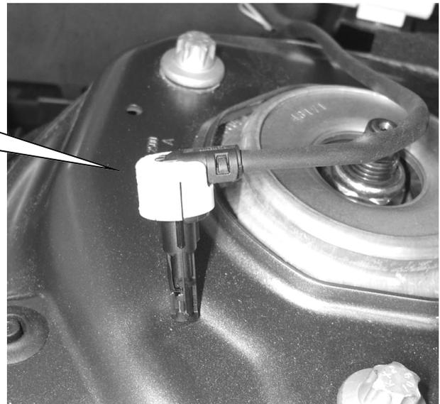
2. Originale Dämpferleitungen mit geeignetem Werkzeug aus der Stecker ausspinnen.
