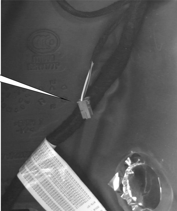
2. Originale Dämpferleitungen mit geeignetem Werkzeug aus der Stecker ausspinnen.
