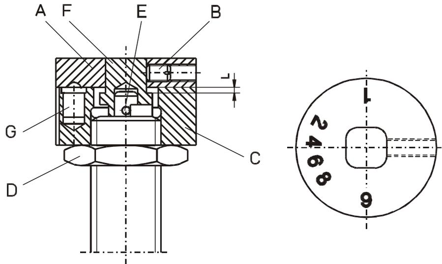
Verstellposition **9** = **weich** (im Uhrzeigersinn drehen)
