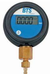
Leider liegen uns von den Fahrzeugherstellern zur Frage des Kurbelgehäuse-Innendruckes keine verlässlichen Herstellerangaben vor. Nachstehende Werte sind Erfahrungswerte aus vielen differenzierten Prüfungen. Grundsätzlich gilt die Aussage, dass ein Kurbelgehäuse-Innendruck in der Regel negativ zu sein hat, Abweichungen nach oben sollten +5 mbar nicht überschreiten, Unterdrücke größer als -90 mbar sind aus technischer Sicht für den Motor bedenklich.
