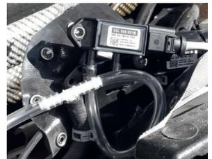
Die Prüfung des Abgasgegendrucks ist immer im Fahrbetrieb auf Drehzahl und Leistung durchzuführen. Dabei empfiehlt es sich, die gefahrenen Kilometer seit der letzten erfolgreichen Regeneration des DPF zu berücksichtigen. Die Obergrenze des vertretbaren Abgasgegendruckes liegt bei +300 mbar.
