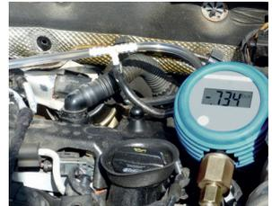
Zur Prüfung aller pneumatischer Aktuatoren an den Turboladern findet das elektronische Manometer unseres Messtools seine Anwendung. An druck- und unterdruckgesteuerten Aktuatoren können die Drücke auch im Fahrbetrieb ermittelt werden. Somit ist ein Vergleich der ermittelten Drücke mit den Taktraten der elektropneumatischen Wandler realisierbar.
