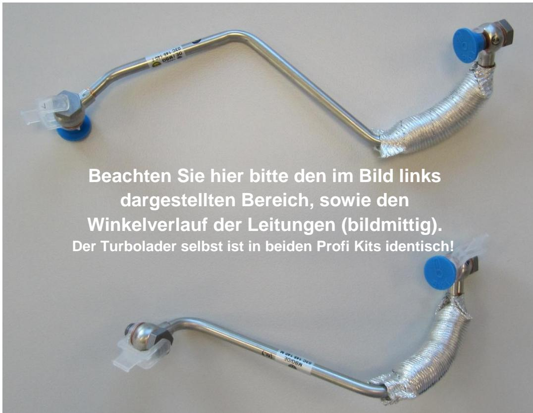
Beachten Sie hier bitte den im Bild links dargestellten Bereich, sowie den Winkelverlauf der Leitungen (bildmittig). Der Turbolader selbst ist in beiden Profi Kits identisch!
