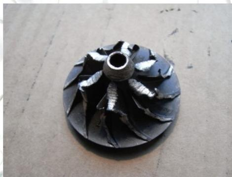
Der hier gezeigte Schaden ist durch Lösen der Mutter vor dem Verdichterrades entstanden. Da diese mit Linksgewinde ausgerüstet ist und die Rotationsbewegung der Welle daher entgegen der Löserichtung der Mutter steht, ist solches nur dann möglich, wenn es wie hier zum abrupten Abstoppen der Läuferwelle kommt (Ölmangel) und sich das Verdichterrad hierbei weiter dreht.
