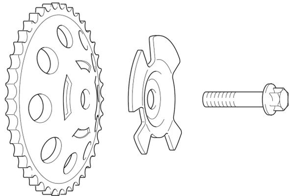
Bild 4: Korrekte Montagereihenfolge an der Einlassnockenwelle beim Austausch von Kettenrädern aus gestanztem Stahlblech.
