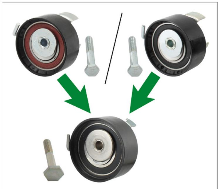
Bild 1: Oben die beiden bisherigen Ausführungen mit roter bzw. schwarzer Dichtung / unten die neue Ausführung
