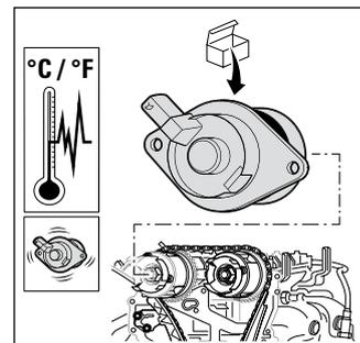
Der Zentralmagnet unterliegt Vibrationen und thermischen Belastungen. Um einem Defekt vorzubeugen, sollte er bei der Reparatur ebenfalls ersetzt werden.
