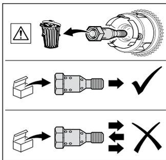
Der Gewindeteil des Zentralventils dehnt sich bei der Montage, daher darf es nach einer Demontage nicht wiederverwendet werden.
