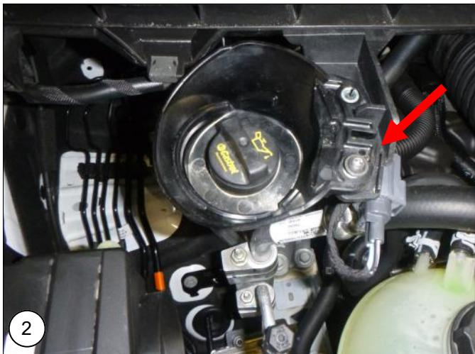
**NL** Verwijder de bevestigingsschroef en leg de motorolie vul slang opzij.
