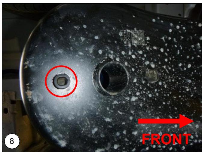
**FR** Nettoyez la surface et appliquez un peu de lubri-fiant sur la fente du caoutchouc du ressort. Réinstallez ensuite le caoutchouc dans l'autre trou du bras de suspension.
