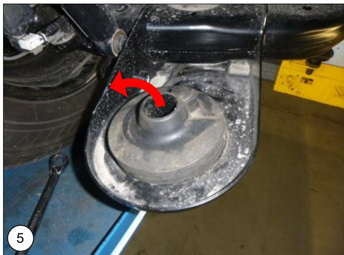
**NL** Verwijder het onderste originele veerrubber aan de **linker achterzijde** van het voertuig.
