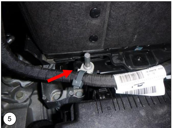
**NL** Demonteer de kabelhouder van de massakabel die aan de accubak is bevestigd.
