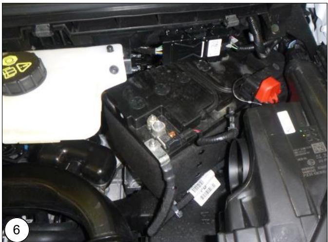
**NL** Koppel de accu los en verwijder deze uit het voertuig.
