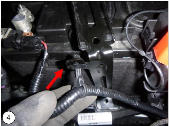
**NL** Maak de kabelbevestiging los die aan de accu-beugel zit.
