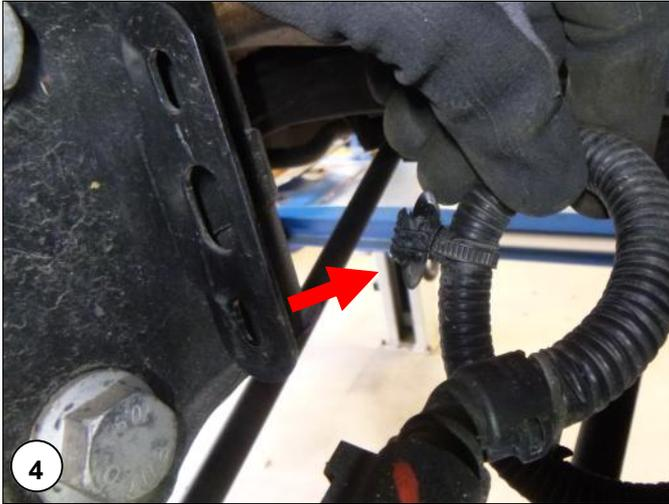
**NL** Verwijder de bevestigingsclip van de elektronische handrem kabel.
