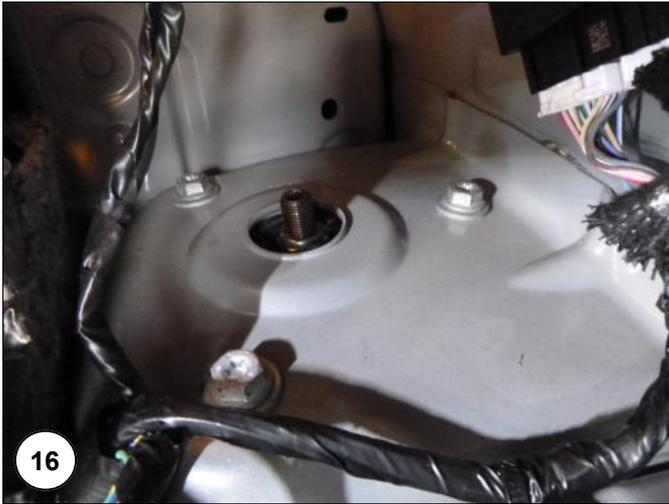
**NL** Draai nu de bovenste 3 bouten van de veerpoot goed vast, en plaats de afdekkappen terug in de kofferruimte.
