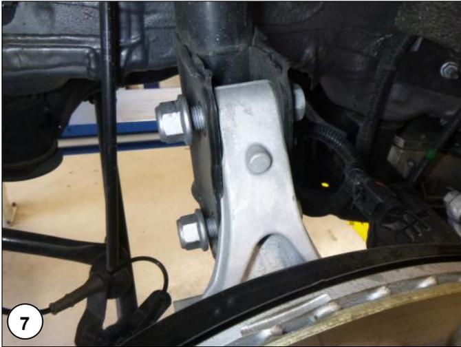
**NL** Draai de moeren van de onderste schokdemperbouten los, verwijder ze nog niet helemaal.
