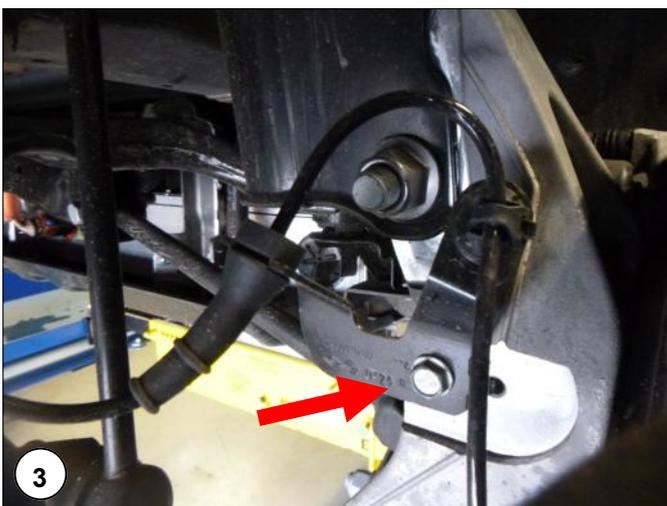
**NL** Demonteer de bevestigingsbeugel van de ABS-kabel.
