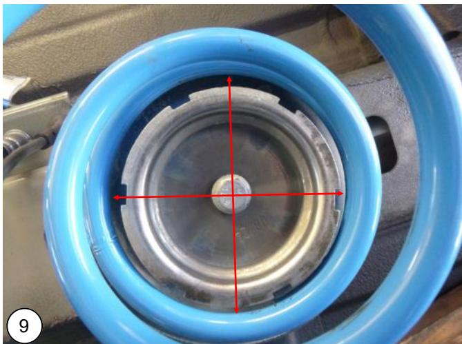
**NL** Zorg ervoor dat de MAD veer goed gecentreerd met de bufferhouder door de boven beugel te verschuiven.
