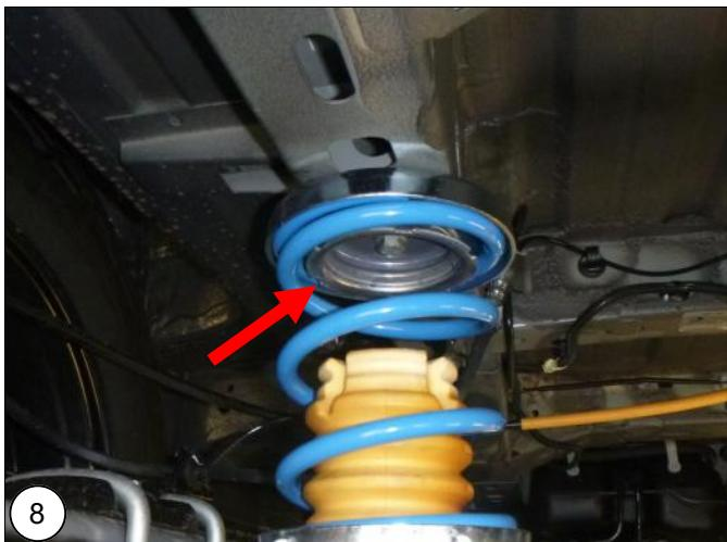
**NL** Plaats de originele bufferhouders terug onder het voertuig, **Draai de bouten nog niet vast!**
