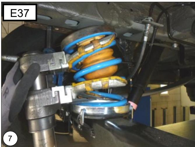
**NL** Gebruik voor de montage van de **E37** hulpveren een veerspanner. (**HV-148210**)
