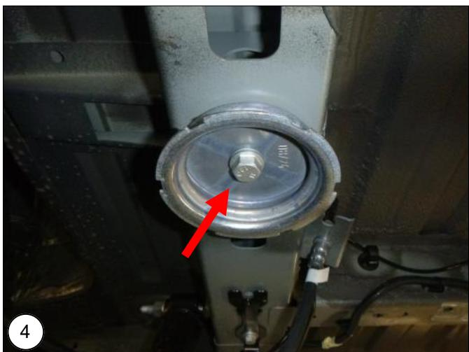
**NL** Verwijder de originele bufferhouders van het chassis.
