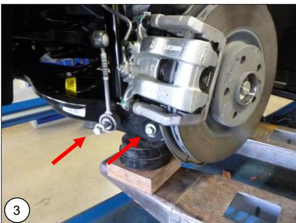
**NL** Ondersteun de draagarm en verwijder de bouten van de schokdemper en de draagarm aan de wielzijde. **Let op! De draagarm staat onder veerspanning.**
