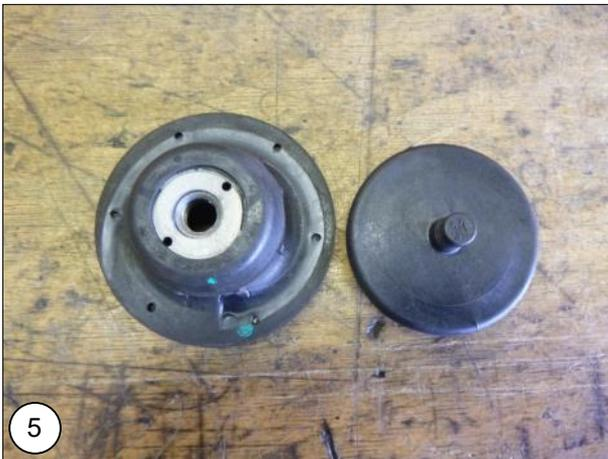
**NL** Neem de bovenste veerrubbers en draai **veerschotels A** in het gat van het veerrubber en verwijder deze weer. Dit is om montage later gemakkelijker te maken.
