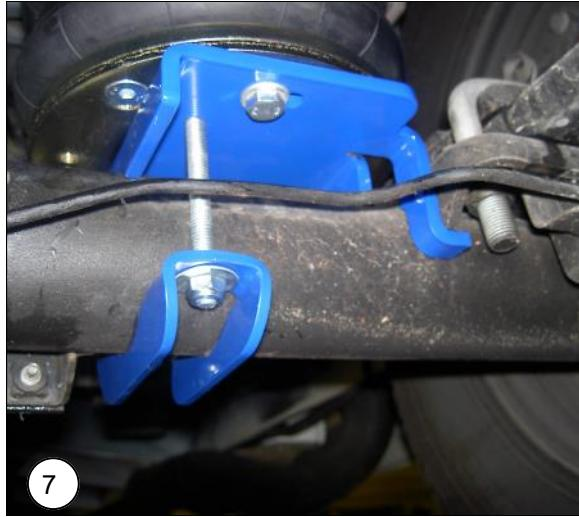
**NL** Zet vervolgens de onderplaat vast op de as met de twee M8 x 100 bouten, klembeugel en twee borgmoeren M8.
