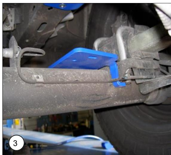
**NL** Voor de onderplaat bevestigd kan worden, moet eerst de remleiding verlegd worden.
