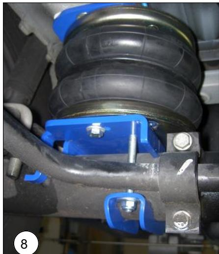
**NL** Monteer de luchtbalg met de luchtaansluiting naar boven, bevestig de bovenzijde en onder zijde met M8x16 bouten en M8 ringen.
