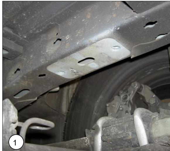
**NL** Verwijder beide aanslagrubbers van het chassis.
