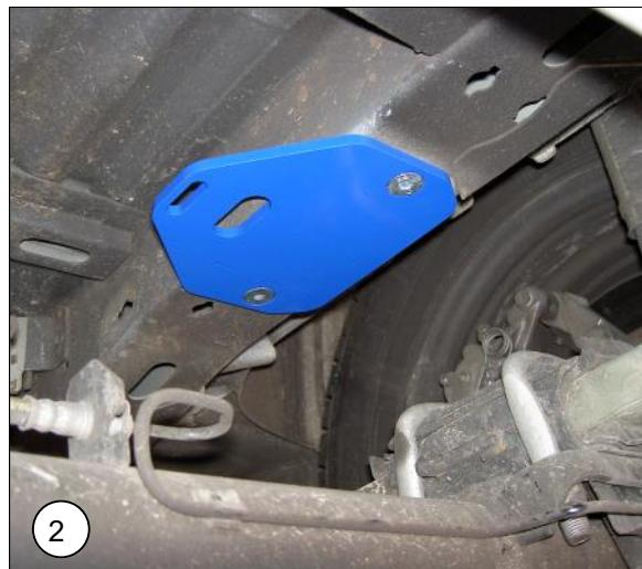
**NL** Plaats nu de bovenplaat op de plek waar het aanslagrubber heeft gezeten, gebruik hiervoor de verzonken bouten M10x20
