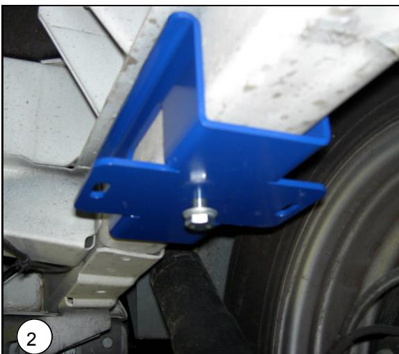
**NL** Plaats nu de bovenplaat, zodat deze strak om de chassisbalk past en zet deze vast met M10 veerring en M10 x 30 x 1,25 bout.
