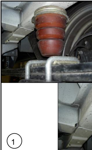
**NL** Verwijder beide aanslagrubbers van het chassis.
