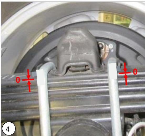
**NL** Controleer of de onderbeugel goed gepositioneerd is. Voertuig iets laten zakken. Zet de veerstroppen vast met het voorgeschreven aanhaalmoment.
