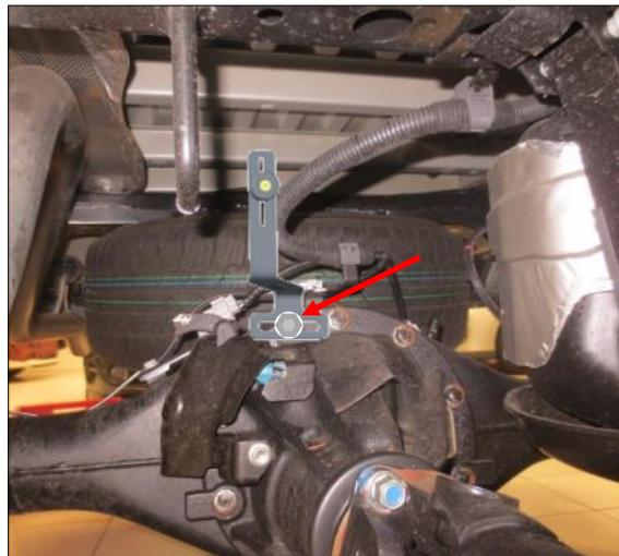
**NL** Monteer de magneetsteun op de achtersas. Gebruik hiervoor de originele bout van het kabel bescherm schild.
