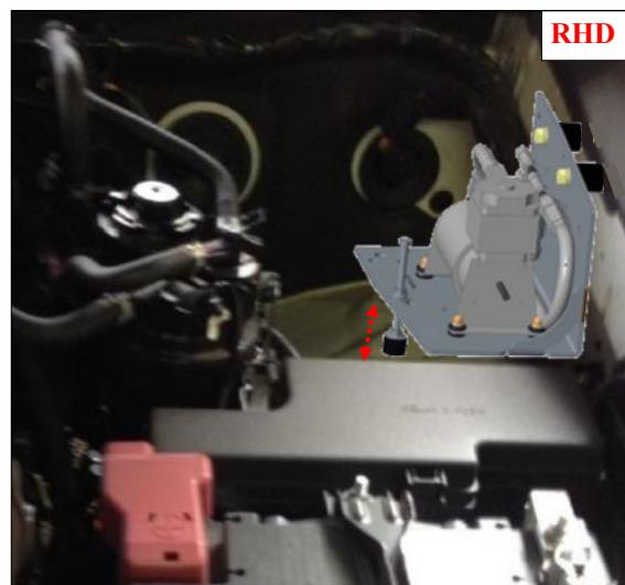
**NL** Alleen **Right Hand Drive**: Monteer de Compressorsteun met compressor zoals aangegeven op de afbeelding. Gebruik meegeleverd montagemateriaal. Zie afbeelding bovenaan. Steun de rubber voet af op de carrosserie.
