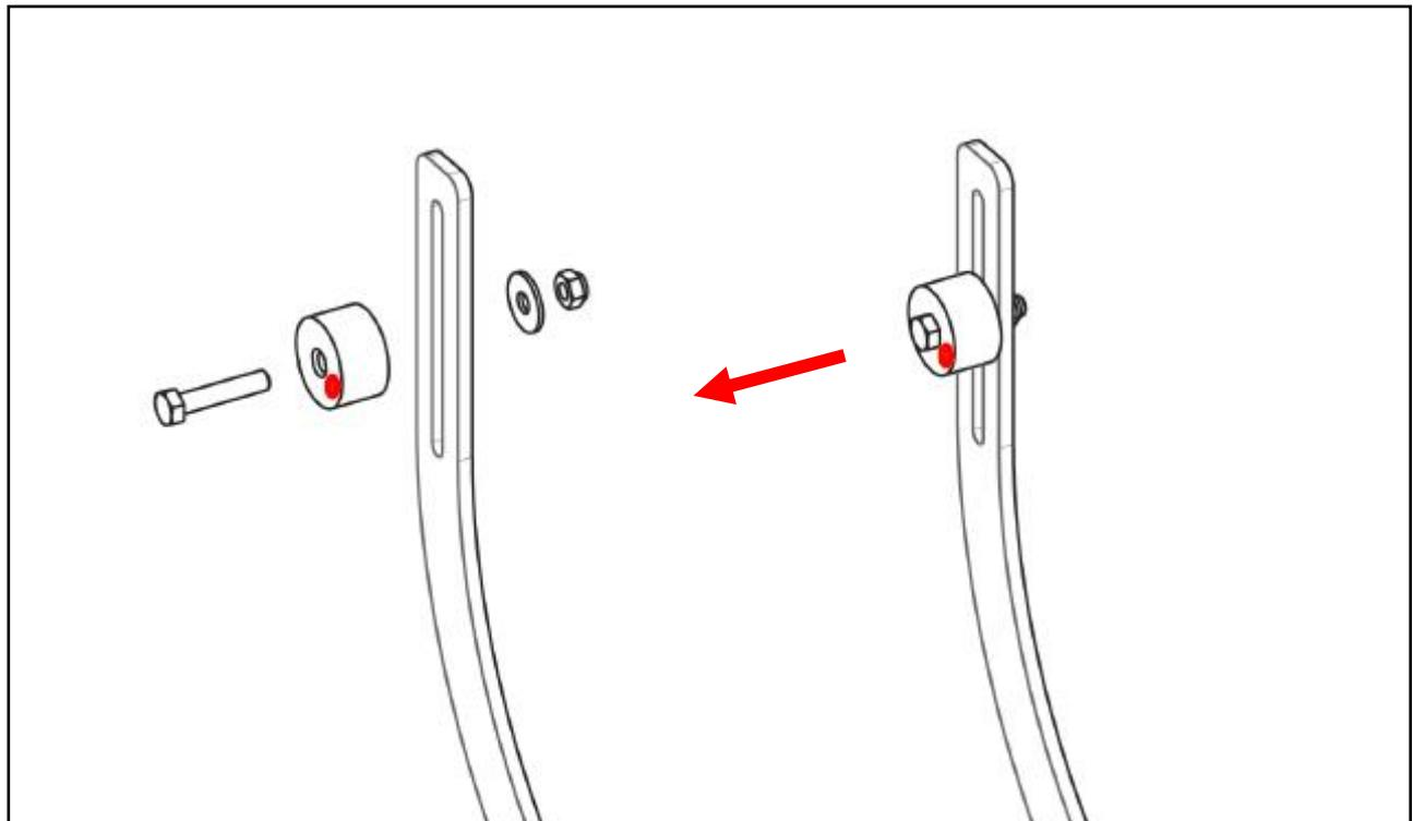
**NL Let op:** zorg dat bij de montage van de Sensor Air Master en de magneet dat de kant met de markering op de magneet naar de sensor toewijst, anders functioneert het systeem niet zoals het hoort.
