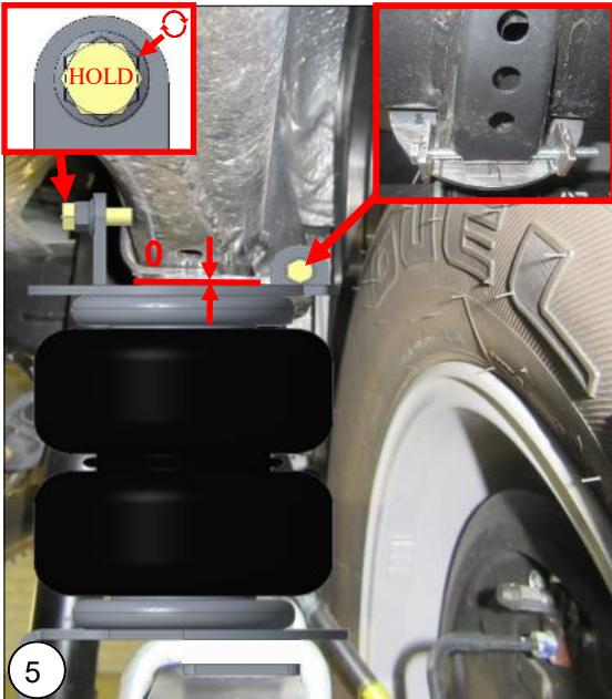
**NL** Zet de bovenbeugel vast op de buffersteun. Draai de M10x30 bout handvast. Borg de bovenbeugel met de M10 bout en contramoer tegen het chassis. Controleer of de luchtbalg niets raakt. Plaats de auto op de wielen.
