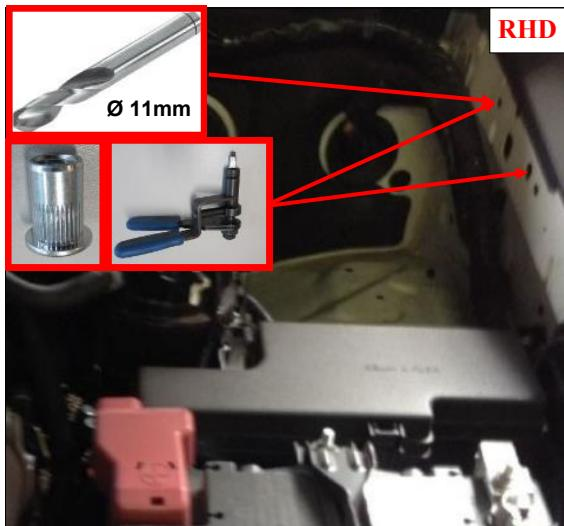
**NL** Alleen **Right Hand Drive**: Bevestigingspunten compressorunit. Links voor in het motorruim. Boor het achterste gat op naar 11mm. Monteer in de 2 gaten de meegeleverde blindklinkmoeren met een blindklinkmoerentang.
