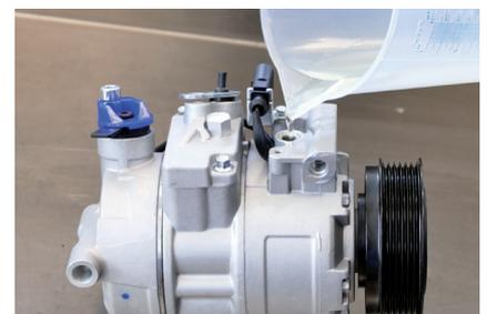
Abbildung 3: Ein R134a-Kompressor mit PAG-46-Ölfüllung kann ebenso mit dem Öl PAO 68 ergänzt werden
