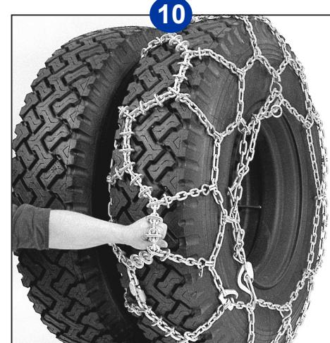
Das freie Ende der Verspannungskette **vom Verschluss weg** (Pfeil) zurückführen um die Verspannungskette schlingen. Verwahrungshaken (6) bei nur leichter Anspannung in die Verspannungskette einhängen. - So ist die Gleitschutzkette richtig aufgelegt und verwahrt.
