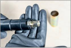
Setzen Sie das passende formbare Felgenschloss in den V7001-1 Werkzeugträger. Achten Sie auf sicheren Halt und Arretierung im Federring.
