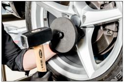
Ist das formbare Felgenschloss formschlüssig in das Felgenschloss eingetrieben kann mit einer Ratsche per Hand das Felgenschloss demontiert werden.
