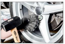
Schlagen Sie diese Einheit in das Felgenschloss, dass sich das formbare Felgenschloss in das Profil arbeiten kann.
