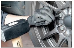
Mit dem Körner schlagen Sie die Auflagefläche als Führung in die Radschraube.
