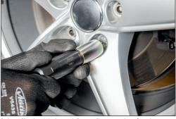
Setzen Sie den Werkzeugträger mit passendem formbaren Felgenschloss und Felgenschutz auf das Felgenschloss.
