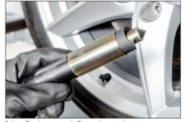
Setzen Sie das passende Demontagewerkzeug für Radschrauben V7001-3 oder V7001-4 in den V7001-1 Werkzeugträger. Achten Sie auf sicheren Halt und Arretierung im Federring.
