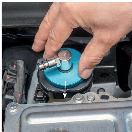
Sl. 5) Pritisnite adapter prema dolje u spremnik kočne tekućine.
