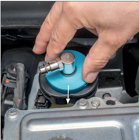
Slika 5 Pritisnite nastavek navzdol na posodo za zavorno tekočino.
