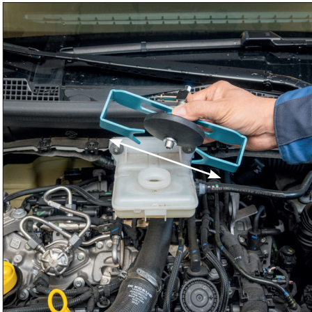
Abb. 7) Öffnen Sie die Arme des Universaladapters.
