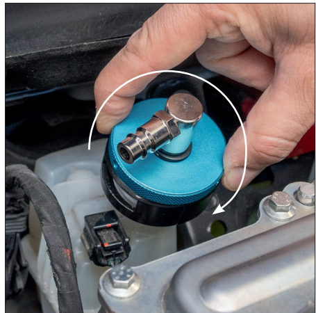
Fig. 6) Închideți brațele și rotiți capacul superior pentru a fixa adaptorul.
