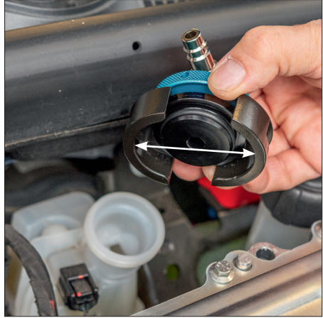
Slika 4 Razširite ročici nastavka.
