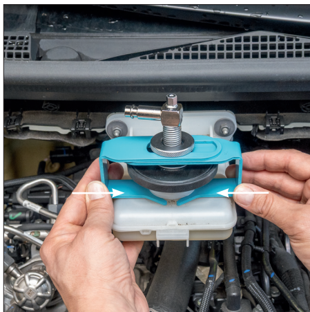
Rys. 9) Zsunąć ramiona do siebie.
