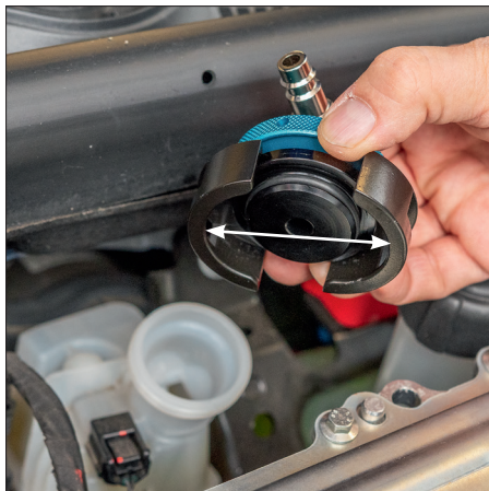
Obr. 4 Rozložte ramená adaptéra.
