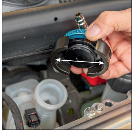
Fig. 4) Desfaceți brațele adaptorului.
