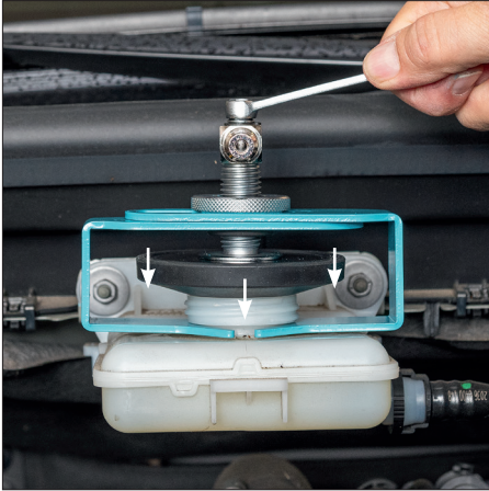
Joon. 11 Keerake koonilise kummitihend väliskuusandi (8 mm) abil pidurivedeliku mahutisse.
