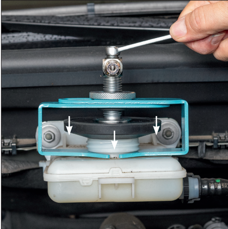
Abb. 11) Drehen Sie über den Außen-sechskant (8 mm) die konische Gummidichtung in den Bremsflüssigkeitsbehälter.
