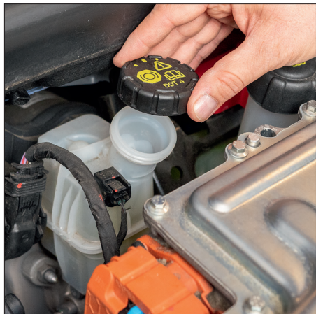
Fig. 3) Retirar a tampa do reservatório de fluido dos travões.
