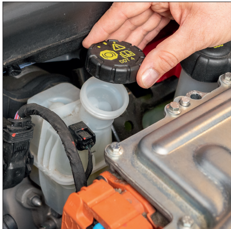
Fig. 3) Retirez le couvercle du réservoir de liquide de frein.
