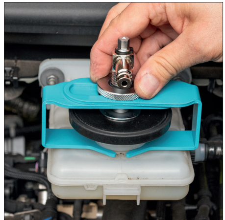
Fig. 10) Fixez les bras à l'aide de l'écrou moleté.
