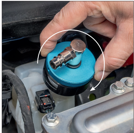
Slika 6 Zaprite ročici in obrnite zgornji pokrov, da pritrdite nastavek.
