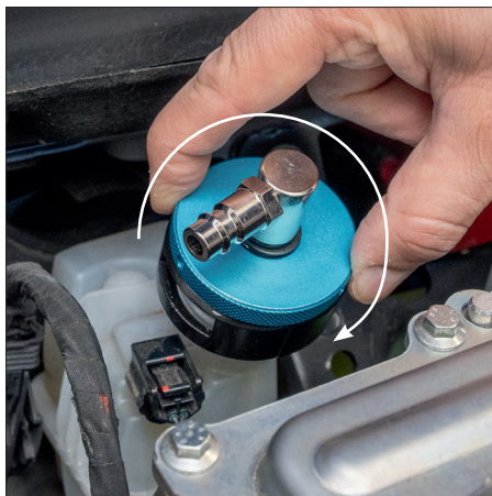
Abb. 6) Schließen Sie die Arme und drehen Sie die obere Abdeckung, um den Adapter zu befestigen.
