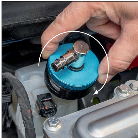
Rys. 6) Zamknąć ramiona i obrócić górną osłonę, aby zamocować adapter.
