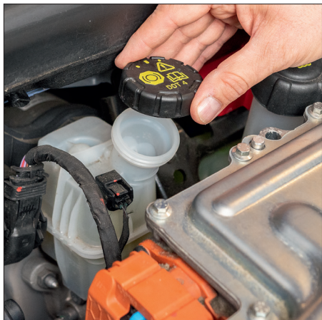
Afb. 3) Verwijder het deksel van het remvloeistofreservoir.
