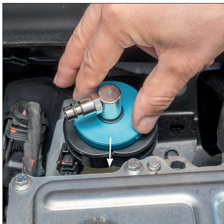
Afb. 5) Druk de adapter naar beneden in het remvloeistofreservoir.
