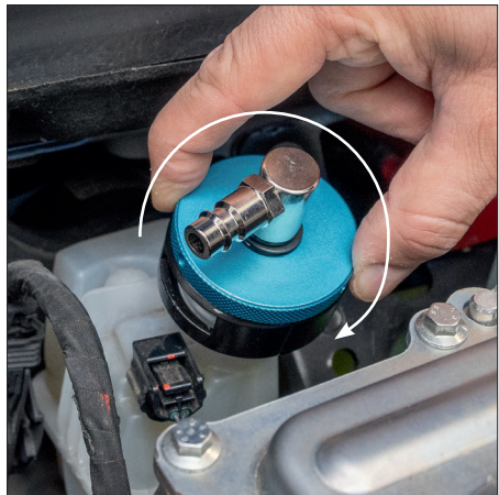
Bild 6) Stäng armarna och vrid på det översta locket för att fästa adaptorn.
