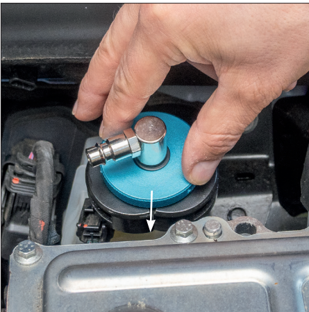
Bild 5) Tryck ner adaptorn i bromsvätskebehållaren.
