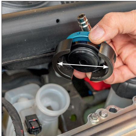
4 pav. Išskleiskite adapterio laikiklius.
