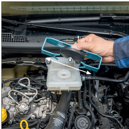
Obr. 7) Otevřete ramena univerzálního adaptéru.
