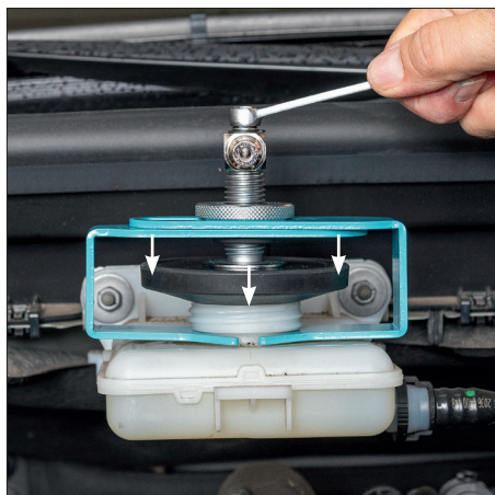
11. att. Izmantojot 8 mm ārējo sešstūri, ieskrūvējiet konisko gumijas blīvējumu bremžu šķidruma rezervuārā atverē.
