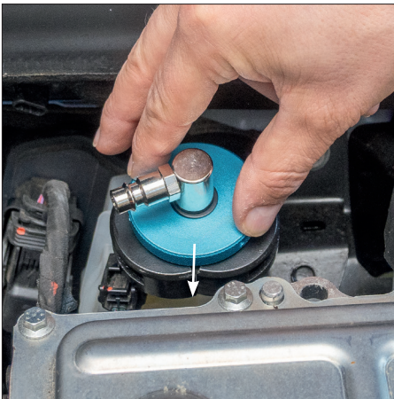
Fig. 5) Apăsați adaptorul în jos în rezervorul de lichid de frână.
