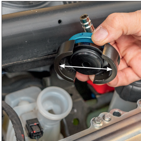
Rys. 4) Rozłożyć ramiona adaptera.
