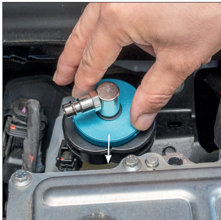
Rys. 5) Wcisnąć adapter w dół do zbiornika płynu hamulcowego.
