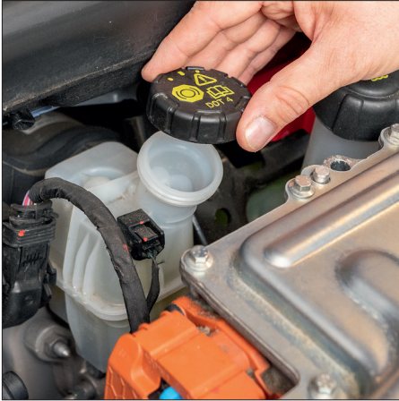
Fig. 3) Îndepărtați capacul rezervorului de lichid de frână.
