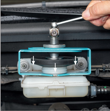
Obr. 11) Pomocí vnějšího šestihranu (8 mm) otočte kónické pryžové těsnění do nádržky brzdové kapaliny.
