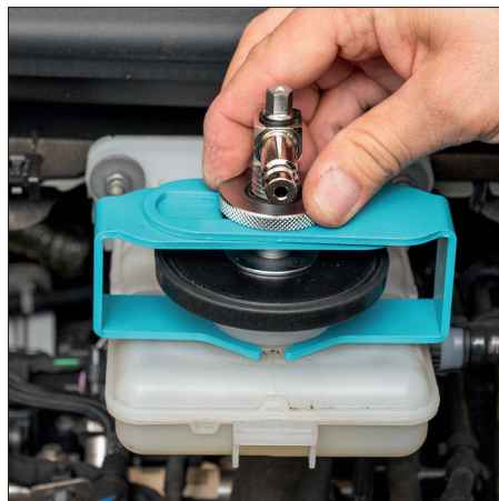
Fig. 10) Fixați brațele folosind piulița zimțată.
