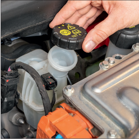
Fig. 3) Rimuovere il tappo del serbatoio del liquido freni.
