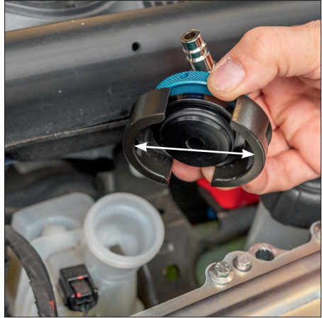
Fig. 4) Allargare i bracci dell'adattatore.
