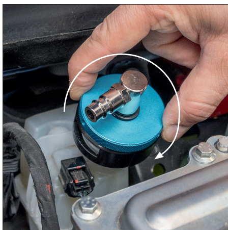
Obr. 6) Zavřete ramena a otočte horní kryt pro připevnění adaptéru.
