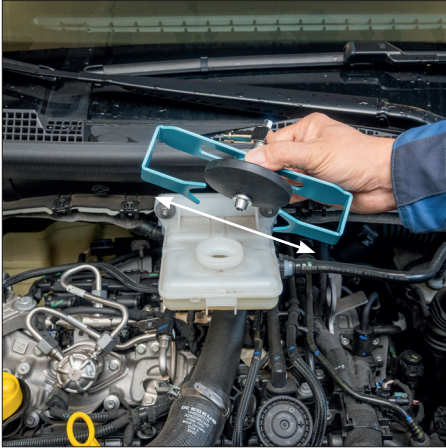
7 pav. Išskleiskite universalaus adapterio laikiklius.
