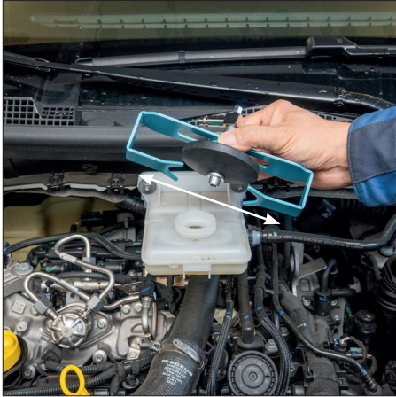
Fig. 7) Ouvrez les bras de l'adaptateur universel.
