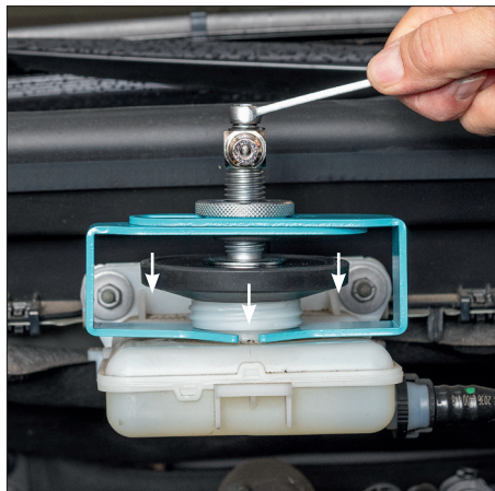
Rys. 11) Użyć zewnętrznego sześciokąta (8 mm), aby obrócić stożkową gumową uszczelkę w zbiorniku płynu hamulcowego.
