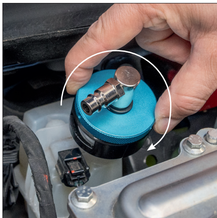
Joon. 6 Sulgege haarad ja keerake adapteri kinnitamiseks ülemist katet.
