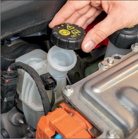
Bild 3) Ta bort locket till bromsvätskebehållaren.
