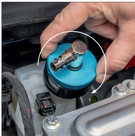
6. att. Aizveriet fiksējošos elementus un, pagriežot augšējo daļu, nostipriniet adapteri.
