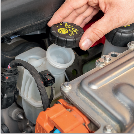
Slika 3 Odstranite pokrovček posode za zavorno tekočino.
