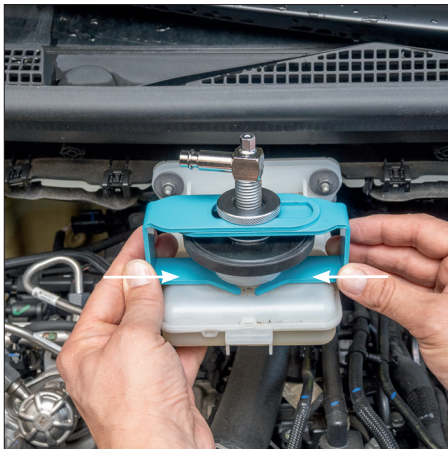
Abb. 9) Schieben Sie die Arme zusammen.
