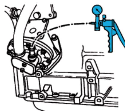
FONCTIONNEMENT DE LA POMPE – FUNKTION DER PUMPE – FUNCIÓN DE LA BOMBA – WERKING VAN POMP
