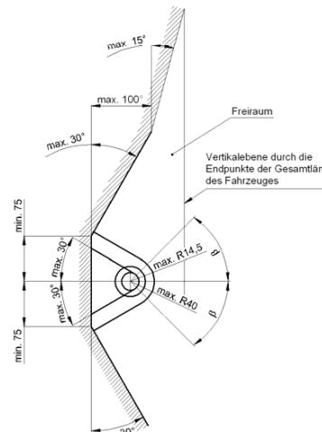
D Der Freiraum nach Anhang 7, Abbildung 25a und 25b der Richtlinie ECE-R 55 ist zu gewährleisten.
