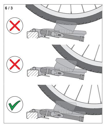
▶ Schieben Sie die Radaufnahmen an das Fahrrad.
