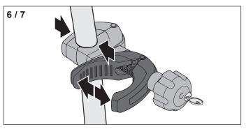
▶ Befestigen Sie die Bügelklemme am Bügel durch Öffnen bzw. Auseinanderziehen und Spreizen der Fahrradklemme.
