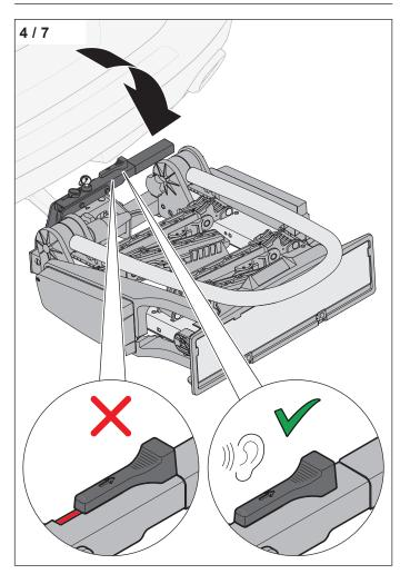
▶ Drücken Sie den Spannhebel mit einer Kraft, die einem Gewicht von 35 kg - 45 kg entspricht, nach unten, bis dieser einrastet.
