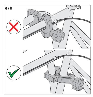
▶ Wählen Sie die Position für eine sichere Fahrradbefestigung.
