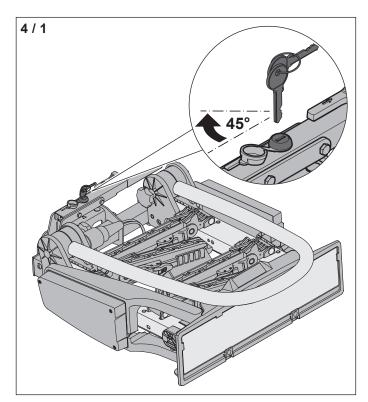
► Schließen Sie das Spannhebelschloss auf.
