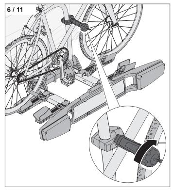
▶ Drehen Sie die Knebelmutter, um das Fahrrad mit der Fahrradklemme zu befestigen.
