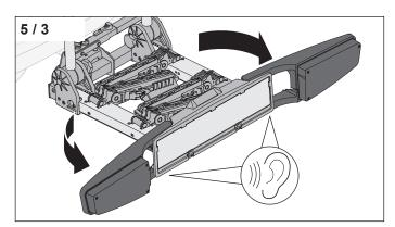
► Klappen Sie beide Leuchtenbügel aus, bis diese einrasten.
