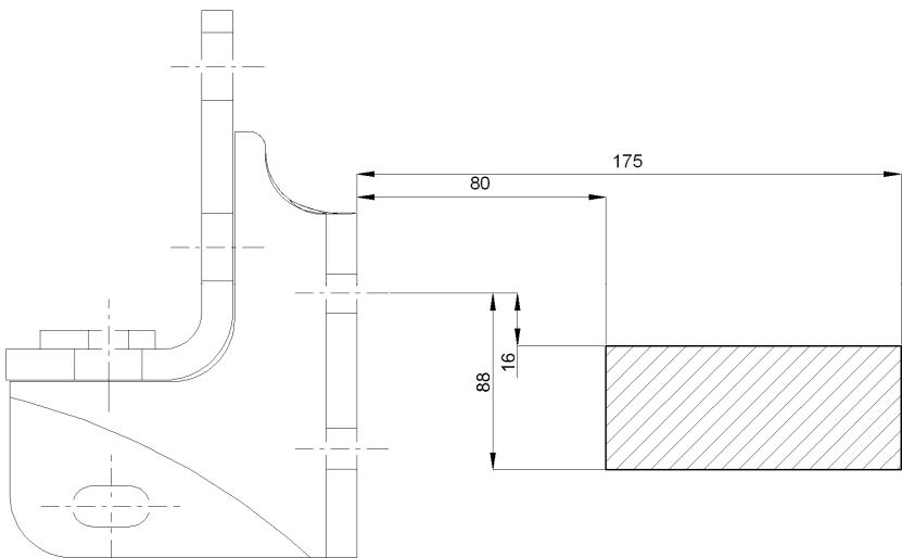
Kuppelbereich für Kupplungskugeln mit Halterung oder selbsttätige Bolzenkupplungen.
