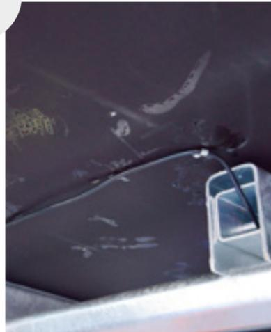
6. Wenn Sie das Kabel an der Anhängerunterseite verlegt haben, kann im nächsten Schritt die Hauptversorgungsleuchte angebracht werden. Schließen Sie dazu die Hauptleitung sowie das Kabel für die Einspeisung der zweiten Heckleuchte an der Hauptversorgungsleuchte an. Führen
