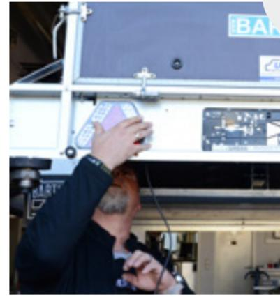
Sie die angeschlossenen Kabel durch den Durchgang am Anhänger und befestigen Sie die Heckleuchte auf der Rückseite mit entsprechenden Muttern.
