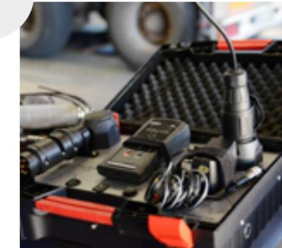
8. Mit dem Anhängerprüfkoffer (Artikelnummer: 95980571) können die Heckleuchten nach vollständiger Montage auf ihre Funktion überprüft werden. Der Vorteil: Mit dem Prüfkoffer kann sowohl die Belegung der Anhängersteckdose als auch die Beleuchtungsfunktion des Anhängers von nur einer einzelnen Person geprüft werden.
