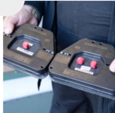
2. Die Hauptversorgungsleuchte besitzt zwei Anschlüsse auf der Rückseite. Ein Anschluss ist für die Stromversorgung und der andere für die Einspeisung der zweiten Leuchte vorgesehen.
