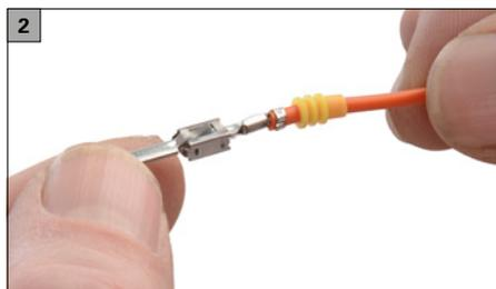
En le décalant de 180°, mettre en place ELA sur l'extrémité du câble.
