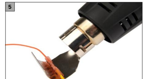
Abschließend erfolgt die Schrumpfung des Verbinders mithilfe eines Heißluftföns.
