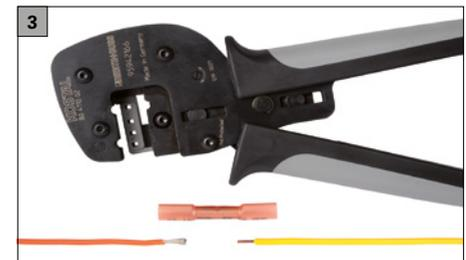
Zur Verbindung kann z.B. ein Quetsch-, Schumpfverbinder verwendet werden. Diese Verbinder sind im Lieferumfang enthalten.
