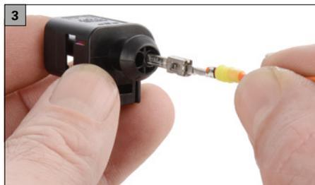
Reparaturkabel anschließend in das Gehäuse einführen.
