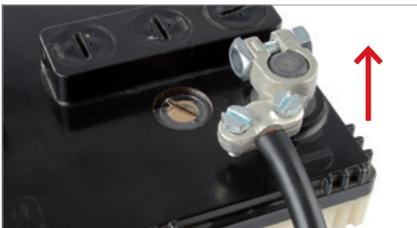
Die bislang am Minuspol angeschlossene Batteriepolklemme vom Pol abmontieren.
