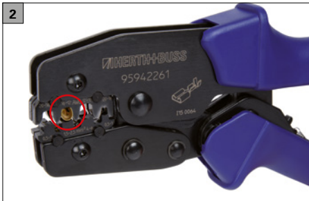
Kontakt in das Profil einlegen und Werkzeug leicht vorschließen, damit Kontakt gehalten wird.
