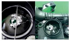
Sicherungsfeder der Fassung öffnen und die Eisenverstrebung abnehmen.
