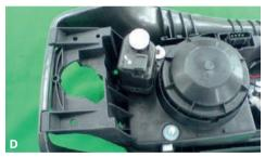
Die Glühlampe nach Vorschrift einbauen und Schutzabdeckung aufsetzen.
