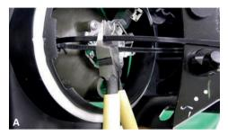
Kabelbinder mit dem Werkzeug durchschneiden. Kabelbinder entfernen.
