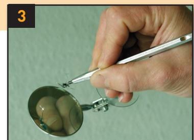
Einschlagstelle mit der Hartmetallnadel von losen Glassplittern und evtl. Verunreinigungen säubern.
