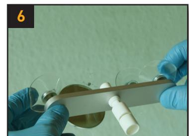
Injektorplattform so ansetzen, dass die Injektordichtung genau über der Einschlagstelle sitzt. Das Öffnen der Sauger mit den Fingern erleichtert die Platzierung.
