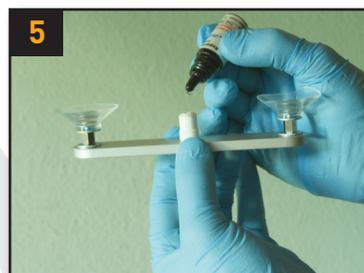
Injektor mit 4-5 Tropfen LIQUI MOLY Reparaturharz (Art.-Nr. 6299) befüllen und die Harzflasche sofort wieder gut verschließen.
