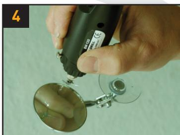
Alternativ kann die Einschlagstelle auch mit der Mini-Bohrmaschine aufgebohrt werden.
