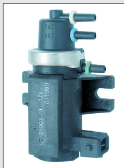
Elektropneumatischer Druckwandler (EPW): Anschlüsse: Vakuum (weiß, oben), Steuerdruck (blau, Mitte), Umgebungsluft (grün, unten), elektrischer Anschluss (ganz unten).
