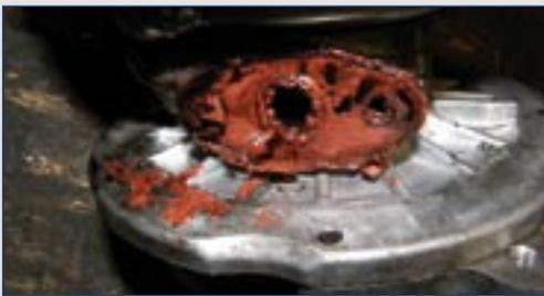
Die Verwendung von Dichtpaste am Ölrücklauf kann zu massivem Ölverlust führen, da nach innen gedrückte Dichtpaste den Querschnitt der Öl Ablaufbohrung verschließt.
