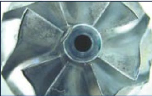
Verdichterradschaufeln im Verdichtergehäuse gleichmäßig angelaufen.
