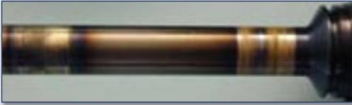
Typisches Schadensbild eines Läufers mit Lagermaterialauftrag des weicheren Radiallagers auf die gehärtete Läuferwelle als Folge von Mischreibung (mangelnde Ölversorgung der Lagerstellen).
