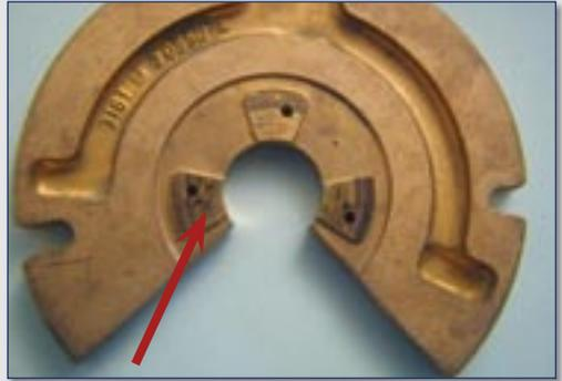
*Verschleiß der Keilflächen. Verfärbung der Keilflächen durch Kontakt (Mischreibung) mit dem Lagerbund und / oder der Dichtungsbuchse.*
