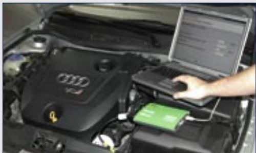
Diagnosegeräte sind ein gutes Hilfsmittel bei der Fehlersuche. Leider kann ein Diagnosegerät nicht erkennen welche Schadensursache am Turbolader vorliegt. Ein Diagnosegerät kann beispielsweise Pfeiffgeräusche nicht lokalisieren oder einen Ausfall des Turboladers wegen Öl-
