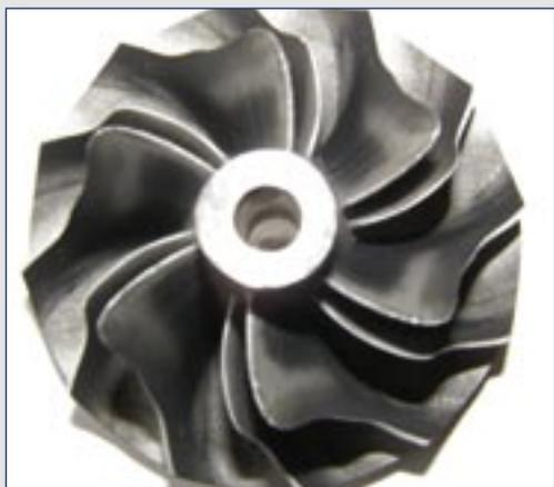
**Mögliche Ursachen:** Betrieb ohne Luftfilter oder undichte Ansaugleitung. Typisches Schadensbild bei Baumaschinen.
