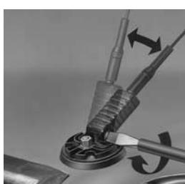
Die Neigung der Rute ist nach Wunsch einstellbar. Falls das Gelenk lose ist, die Schraube anziehen.
