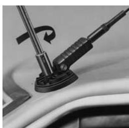
Danach die Sechskantmutter anziehen. Anziehdrehmoment  $3\pm0,5$  Nm.
