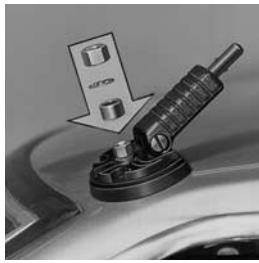
Distanzring, Zahnscheibe und Mutter aufsetzen und leicht anziehen.
