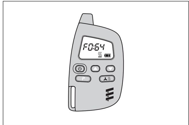
Nachdem die Diagnoseleitung (blau / weiß) angeschlossen wurde und die ersten Protokolle am Stationärteil angekommen sind, kann die Diagnose mit dem Mobilteil der Funkfernbedienung TP5 durchgeführt werden. Der aktuelle Fehler „F0“ wird angezeigt. Die gespeicherten Fehler „F1“ bis „F5“ können angezeigt werden.
