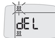
Der Fehlerspeicher ist gelöscht und das Steuergerät entriegelt.
