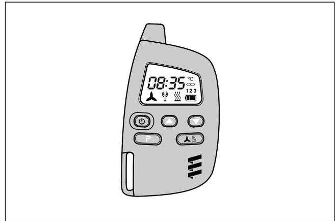
Nachdem die Diagnoseleitung (blau / weiß) angeschlossen wurde und die ersten Protokolle am Stationärteil angekommen sind, kann die Diagnose mit dem Mobilteil der Funkfernbedienung TP5 durchgeführt werden. Der aktuelle Fehler „F0“ wird angezeigt. Die gespeicherten Fehler „F1“ bis „F5“ können abgefragt werden. Die Störung ist entsprechend der Störungssuche und Reparaturanleitung des Heizgerätes zu beheben.
