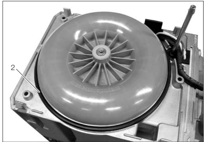
2 O-Ring, an der Steuergerät / Gebläseeinheit angelegt
