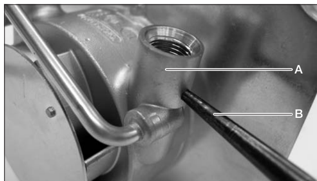
A Rechter Kerzenstutzen B Spitzer Gegenstand zur Reinigung der Zündluftbohrung.
