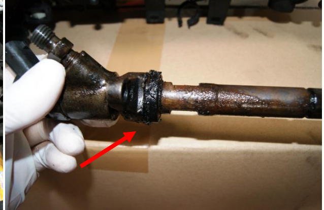
Bild 2: Halterung am Düsenstock undicht
