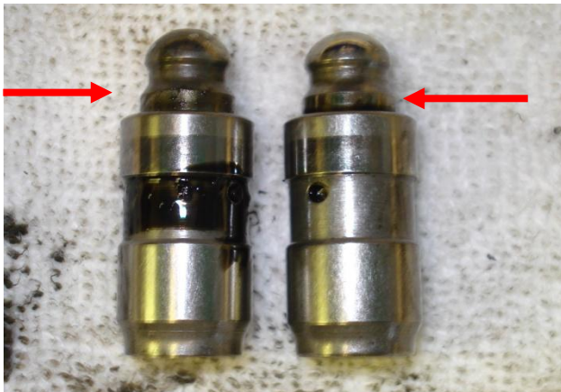
Bild 3: Hydrostößel li. maximal ausgefahren, Ventile dichten nicht
