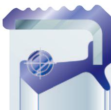
Standard Radialwellendichtung (Bauart ASW)
