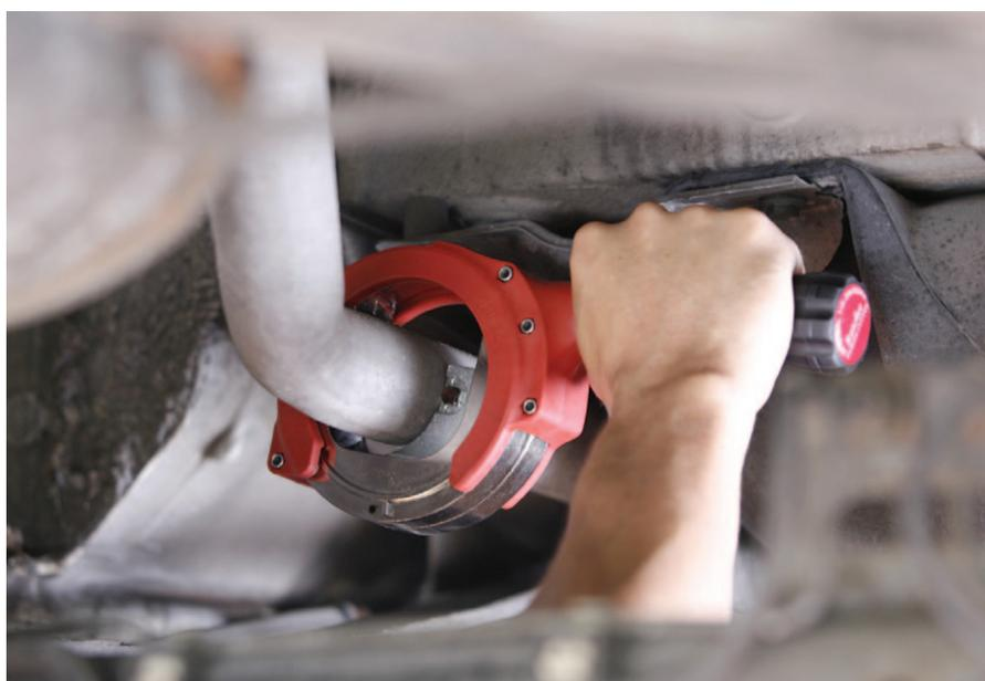
„Durch die Ratschenfunktion muss der Griff des Abschneiders nicht um das Rohr herumgeführt werden. Das spart Platz und hält den Montageaufwand gering!“
